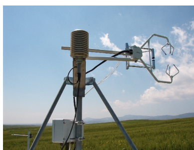
Figure 16: Mesure de l'évapotranspiration réelle à l'échelle locale. Anémomètre sonique et hygromètre optique à hauteur de 2m du sol
