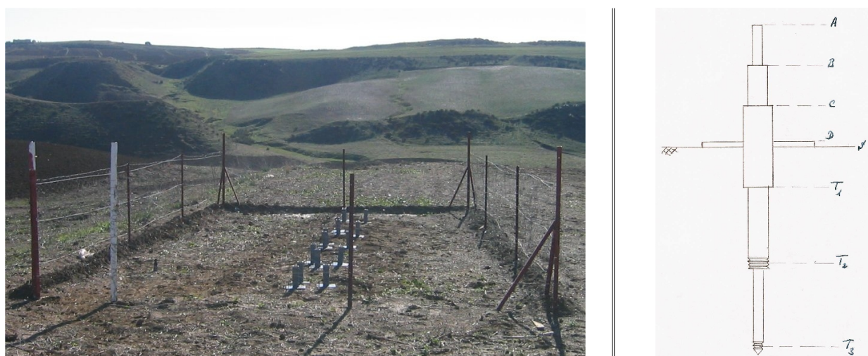
Figure 21. Parcelles de mesures du gonflement-retrait et coupe schématique d'un dispositif « THERESA »
