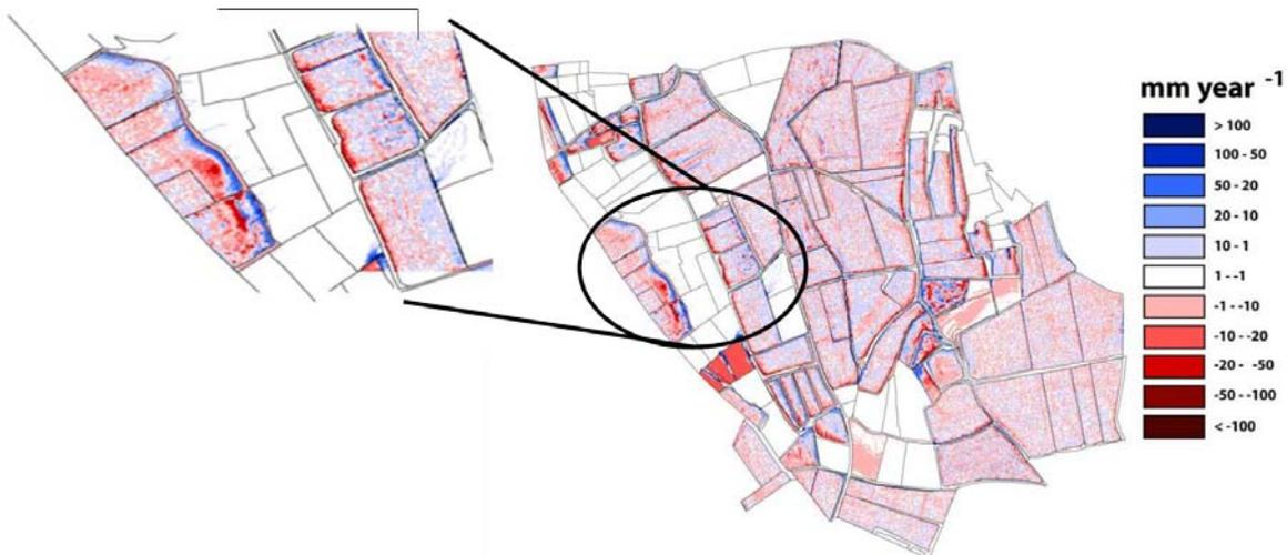
Cette modélisation a été réalisée grâce à Landsoil, modèle distribué combinant érosion hydrique et aratoire. Sur le scénario présenté, le modèle montre une forte redistribution intra-parcellaire du sol liée à une prédominance de l'érosion aratoire (60%) par rapport à l'érosion hydrique (40%), et une exportation nette au niveau de l'exutoire du bassin de 0,31 T/ha/an.
